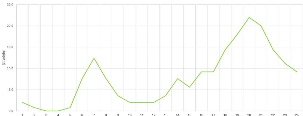
Rysunek 6-5 Profil zapotrzebowania na CWU w gospodarstwie domowym. Źródło: Wyniki projektu ComBioTES, oprac. IEO.
